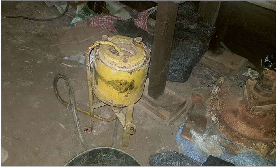
Foto 13 Equipo quemador de retorta.
