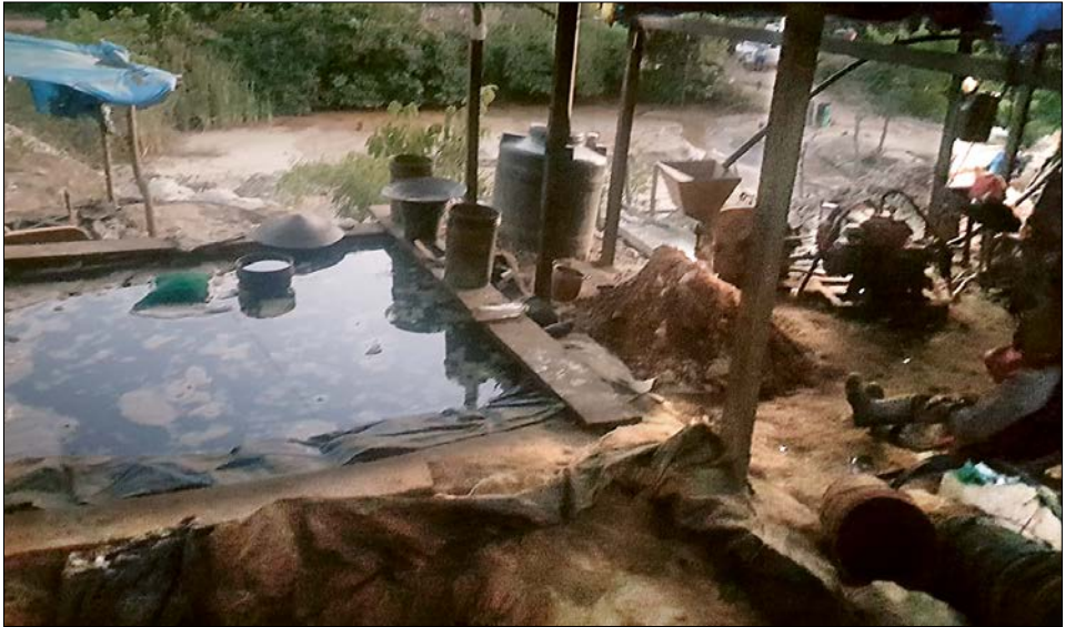
Foto 11 Piscina de depuración para obtener oro amalgamado.
