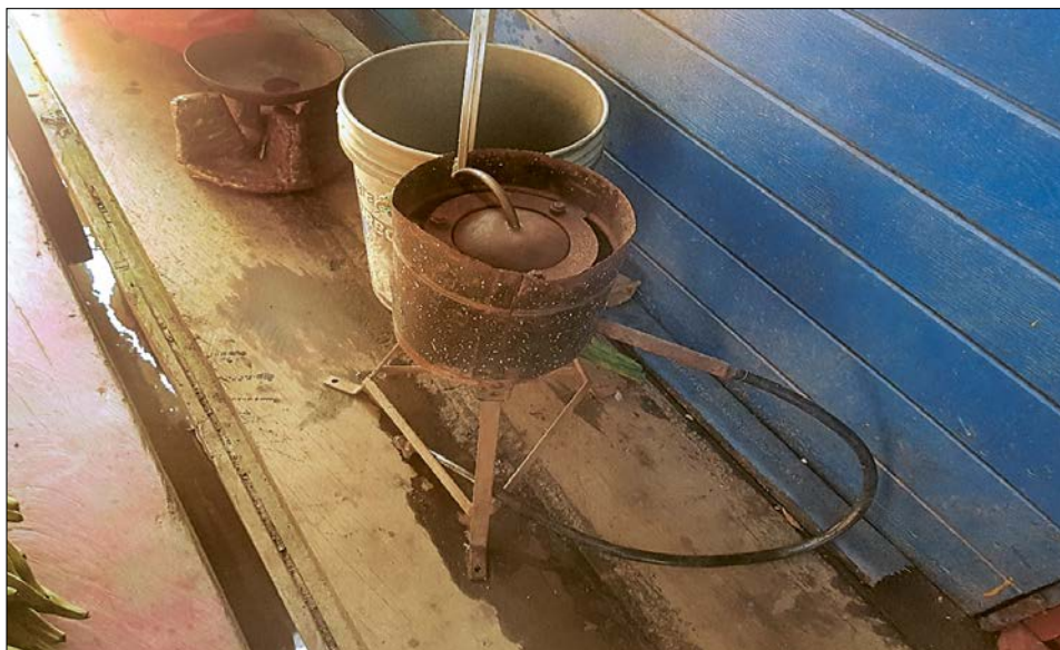
Foto 20 Equipo quemador de oro amalgamado - retorta (2019).
